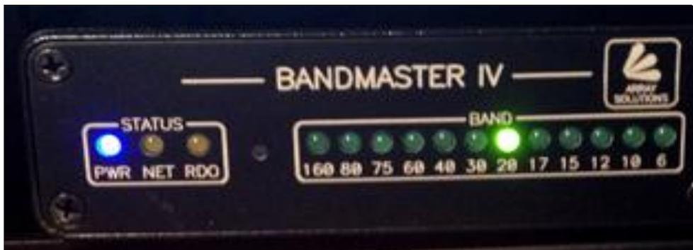
Usando el puerto USB (RS232) o la información de datos de banda (BCD), el Bandmaster IV permite el control automático de su estación usando los accesorios de Array Solutions / Hamation.
